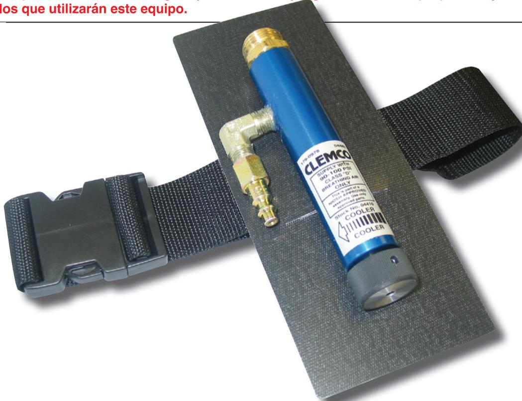
**VISIÓN GENERAL** El tubo de aire frío (CAT) de Clemco permite al operador de chorro controlar la temperatura y el volumen de aire a un respirador de aire de flujo continuo Clemco Apollo HP Tipo CE dentro de un rango preestablecido y enfriar la entrada aire comprimido hasta 50 ° F
